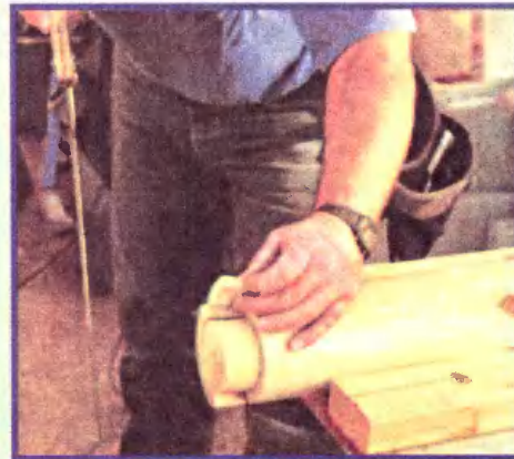
Изготовление круглых шипов: надежно закрепляем брус; кольцевой пилой делаем пропил и удаляем лишнее; после легкой обработки наждачной бумагой брус готов к установке.
