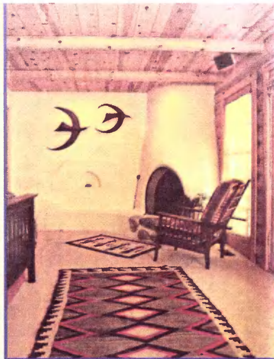
Спальня. Гипсокартонные плиты перегородок и ниш оштукатурены. Фото с точки E на плане дома.
